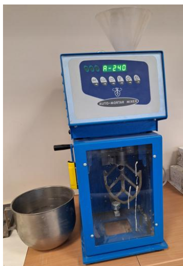
2 pav. Skiedinio maišytuvai Fig. 2 Mortar mixer
