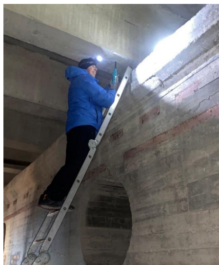
2 pav. Neardantieji stiprio gniuždant bandymai
