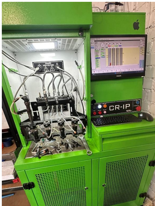
1 pav. Purkštuvų testavimo stendas „Open System CR-IP“ Fig. 1 Injector Test Bench “Open System CR-IP”
