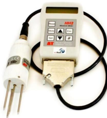
1 pav. Substratų fizikinių savybių matavimo prietaisas „HH2 Moisture Meter“ Fig. 1. Device of measuring the physical properties of substrate „HH2 Moisture Meter)
