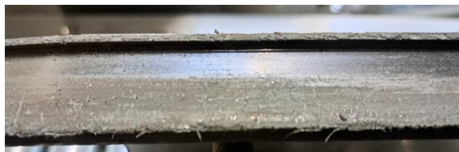
2 pav. Nusidėvėjęs kreipiančiosios profilis Fig. 2. Worn guides
