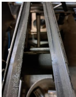
1 pav. Nusidėvėjęs kreipiančiųjų profilis Fig. 1. Worn guides
