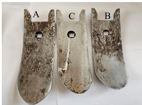
4 pav. Kaltai įdirbė 45-50 ha plotą: A – netekstūruoti kaltai, B – tekstūruoti „V“ forma, C – tekstūruoti „=“ forma.
