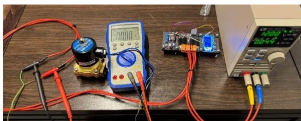
3 pav. Elektromagnetinio vožtuvo atsidarymo tyrimas su IPM Fig. 3. Valve opening test with IPM
