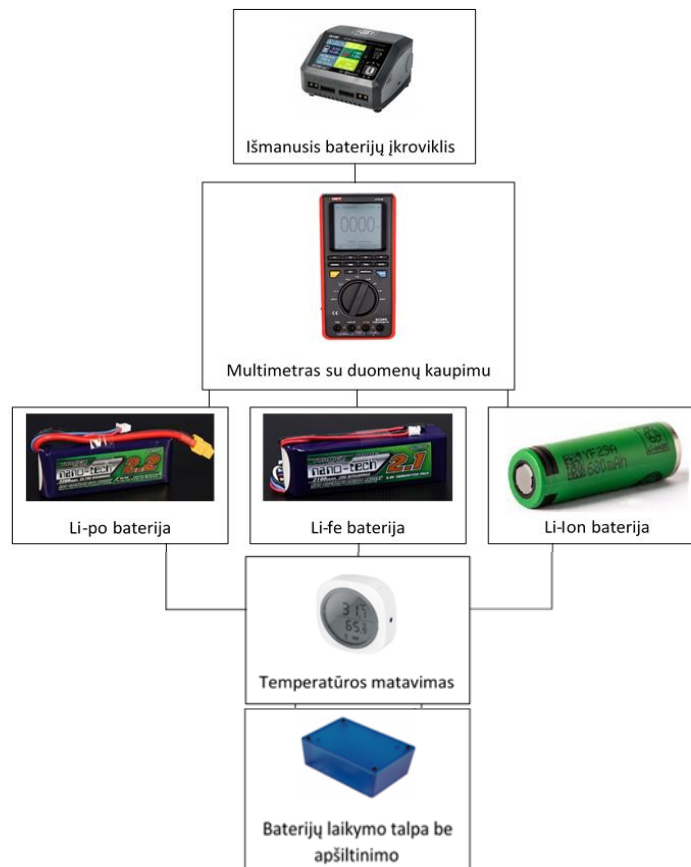
1 pav. Suprojektuoto baterijų bandymo stendo schema
