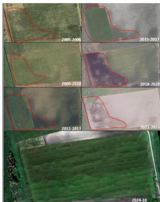
2 pav. Ortofotografinių nuotraukų (2005–2024 m.) rinkinys su pažymėta (raudonai) netinkamai veikiančia drenažo sistema Fig. 2 Orthophotographic photos (2005–2024 year) set with marked (red) malfunctioning drainage system.
