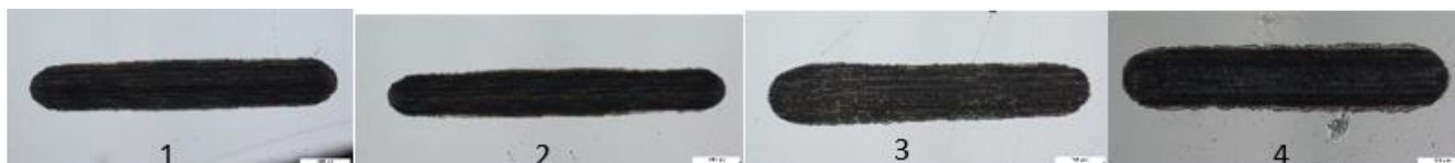
7 Pav. Nudilusių pėdsakų vaizdai plokštelėse: 1) 0W-20 10Hz; 2) CuO 0.1% 10Hz; 3) 0W-20 50Hz; 4) TiO 2 0.1 % 50Hz 7 fig. Images of worn marks on plates: 1) 0W-20 10Hz; 2) CuO 0.1% 10Hz; 3) 0W-20 50Hz; 4) TiO 2 0.1% 50Hz
