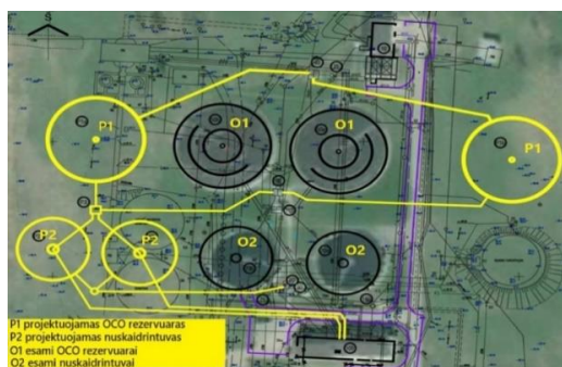
3 pav. Nuotekų valymo įrenginių ir pagrindinių vamzdynų išsidėstymas sklype (alternatyva Nr. 2) Fig. 3. Location of wastewater treatment plants and main pipelines on the site (Option 2)
