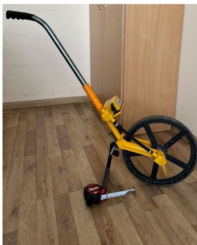
2 pav. Atstumo matavimo ratukas ir matavimo juosta (Autorės nuotrauka, 2023)
