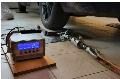
1 pav. Padangos stabdymo jėgos matavimas naudojant prietaisą „AEP transducers TC-TM-50 kN“
