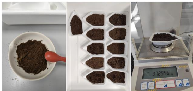
2 pav. Drėgmės nustatymas gravimetriniu metodu laboratorijoje.
