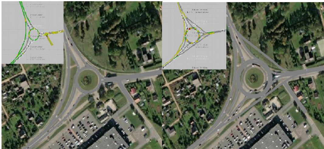
4 pav. Tobulinamos žiedinės sankryžos A modelis („turbo“ žiedinė sankryža su dviem papildomais nuvažiavimais) Fig. 4. Model A of improved roundabouts (turbo roundabout with two additional exits)
