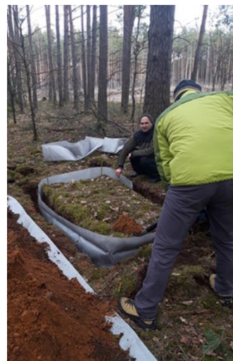
2 pav. Ilgalaikių dirvožemio prakasų įrengimas paprastosios pušies medyne Kačerginės miške Fig. 2. Installation of long-term soil profiles in Scots pine site in Kačerginė forest
