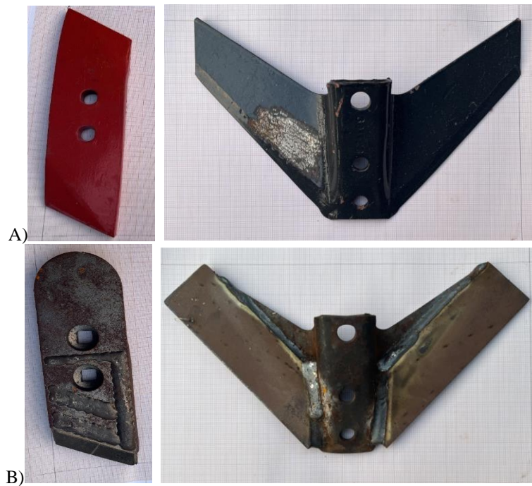
2 pav. Bandomų detalių (kaltų ir strėlinių noragėlių) vaizdai (A – originalus, B – stiprintas kaltas ir atnaujintas strėlinis noragėlis) Fig. 2. Used point and wing (A – original, B – reinforced point and upgraded wing)
